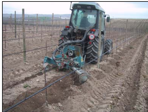
Fig. 6. Lavorazione del terreno con attrezzo interceppo a dischi verticali.
