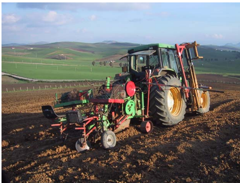
Fig. 1. Trapiantatrice in fase di messe a dimora delle barbatelle.
