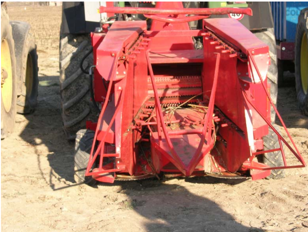
Fig. 16. Particolare della testata di raccolta della macchina. Raccoglitrice della ditta Spapperi.
