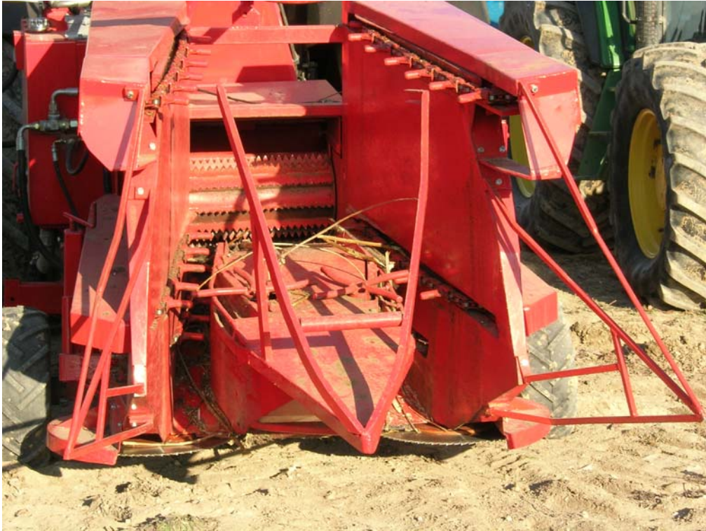
Fig. 17. Particolare della testata di raccolta della macchina. Raccogliatrice della ditta Spapperi.
