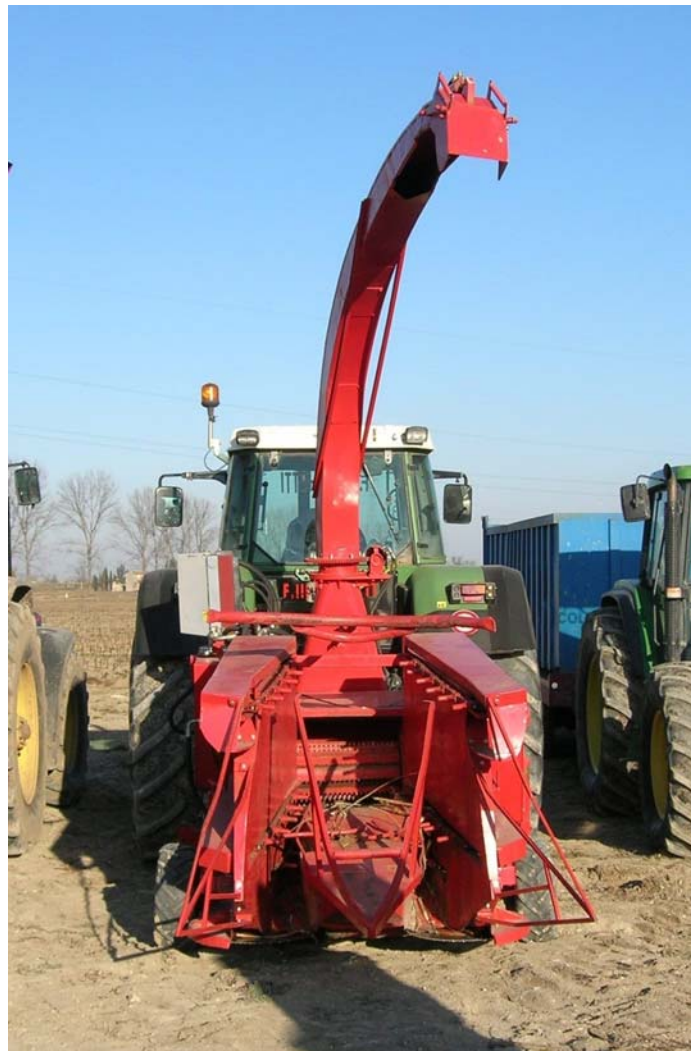
Fig. 15. Macchina impiegata per la raccolta. Raccogliatrice della ditta Spapperi.
